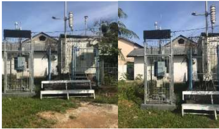
Gambar 2. 23 Alat Pemantauan (AQMS) dan Kegiatan Pemantauan Kualitas Udara
